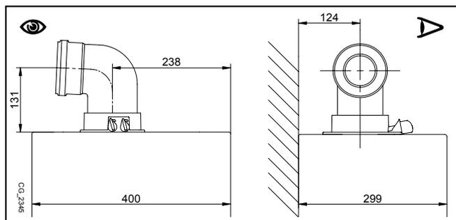
Upevnite nasávacie potrubia pomocou dvoch pozinkovaných skrutiek s  $\varnothing$  4,2 mm a maximálnou dĺžkou 19 mm.
