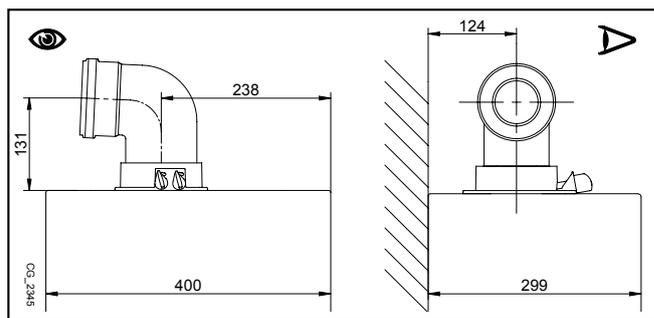
Upevněte nasávací potrubí pomocí dvou pozinkovaných šroubů s  $\varnothing$  4,2 mm a maximální délkou 19 mm.
