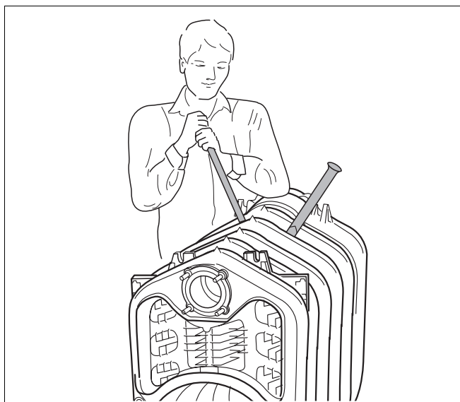
Obr. 30 Oddělení kotlových bloků
