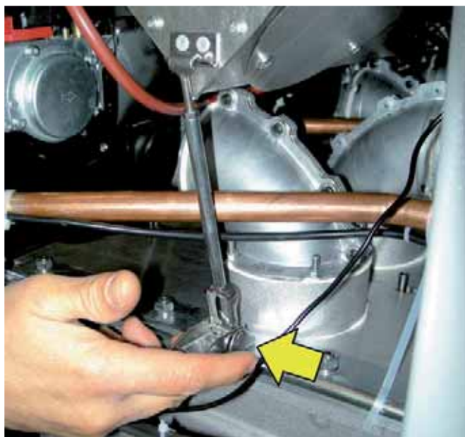
- Sejměte upevňující pružinu z komory ventilátorů (pravá/levá strana).
