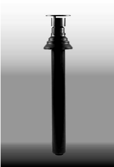
Obr. č. 19 Komínek pro instalaci přes střechy trubky soustředné \phi 60/100, tlaková ztráta: 21 Pa
