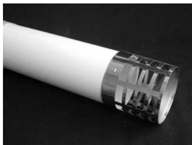
Obr. č. 17 Trubka pro odvod spalin nebo přívod vzduchu s vyúštěním přes zeď \phi 80 mm, tlaková ztráta: 10 Pa
