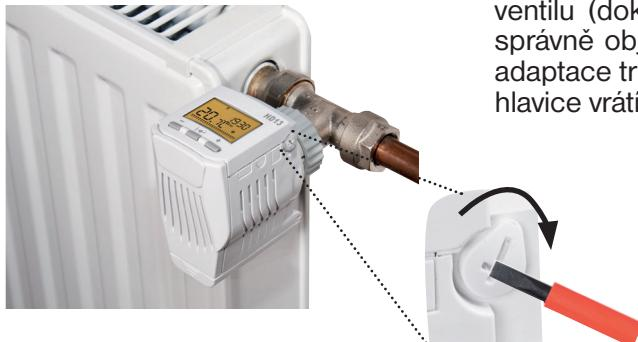
Po nasazení hlavice na ventil se na displeji objeví nápis "Ad:AP" a hlavice se automaticky přizpůsobí ventilu (dokud neproběhne adaptace správně objevuje se i nápis Err). Tato adaptace trvá cca 1min., poté se hlavice vrátí do normálního režimu.
