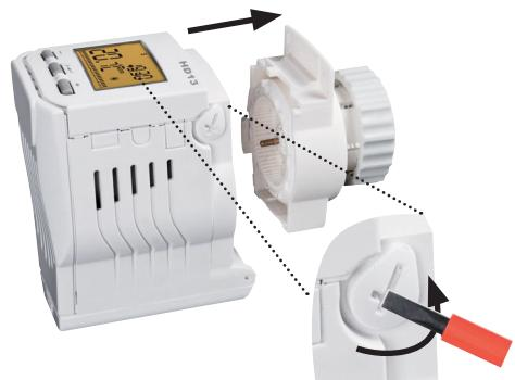
4.4 Uchopte těleso hlavice displejem směrem nahoru, zkontrolujte zda páčka západky směřuje také vzhůru. Potom těleso naklapněte z vrchu dolů na ventil s převodovou částí.
