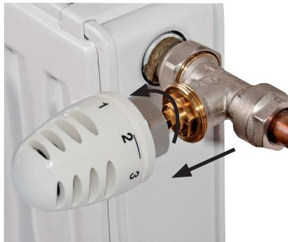
4.3 Uchopte převodovou část hlavice HD13-L, vyšrouubujte ozubené kolečko proti směru hodinových ručiček až na doraz. Nasad'te převodovou část s maticí na ventil a rukou dotáhněte matici na ventil (NEPOUŽÍVEJTE ŽÁDNÉ NÁSTROJE!).
