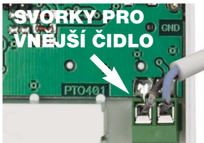
Obr.1 Připojení vnějšího čidla
