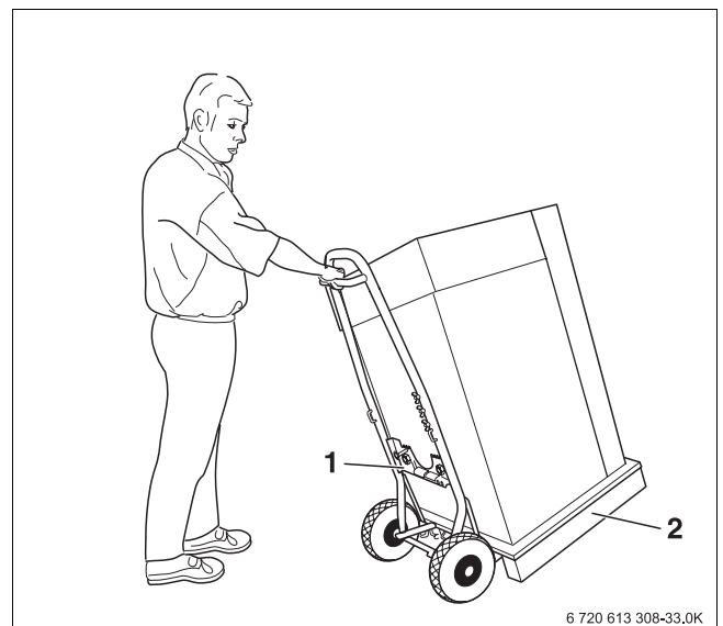
Obr. 7 Zajištění kotle na ručním dvoukolovém vozíku
