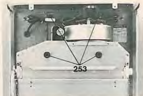
obr. 21 Přístroj se zasune na doraz ke zdi, při čemž svorkovnice odkoušení (253) musí projít odpovídajícími otvory v zadní stěně přístroje. Přístroj se řádně upevní příslušnými maticemi. Dotáhnou se všechna šroubení na montážní připojovací liště.
