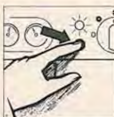
Kontrolka svítí (nedošlo k zapálení) Stisknout odblokování (kontrolka zhasne) zapálení se opakuje.
