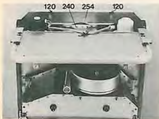
obr. 19 Přístroj se nasadí závěsnou lištou (254) na skříňku odkoušení (240) a přisune ke zdi. Při malé nosnosti zdi je možno přístroj dodatečně připevnit do závěsných ok. (120).
