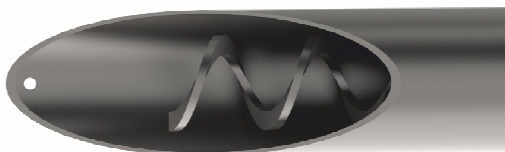
Obr. č. 15 Montáž šnekovnice podavače
