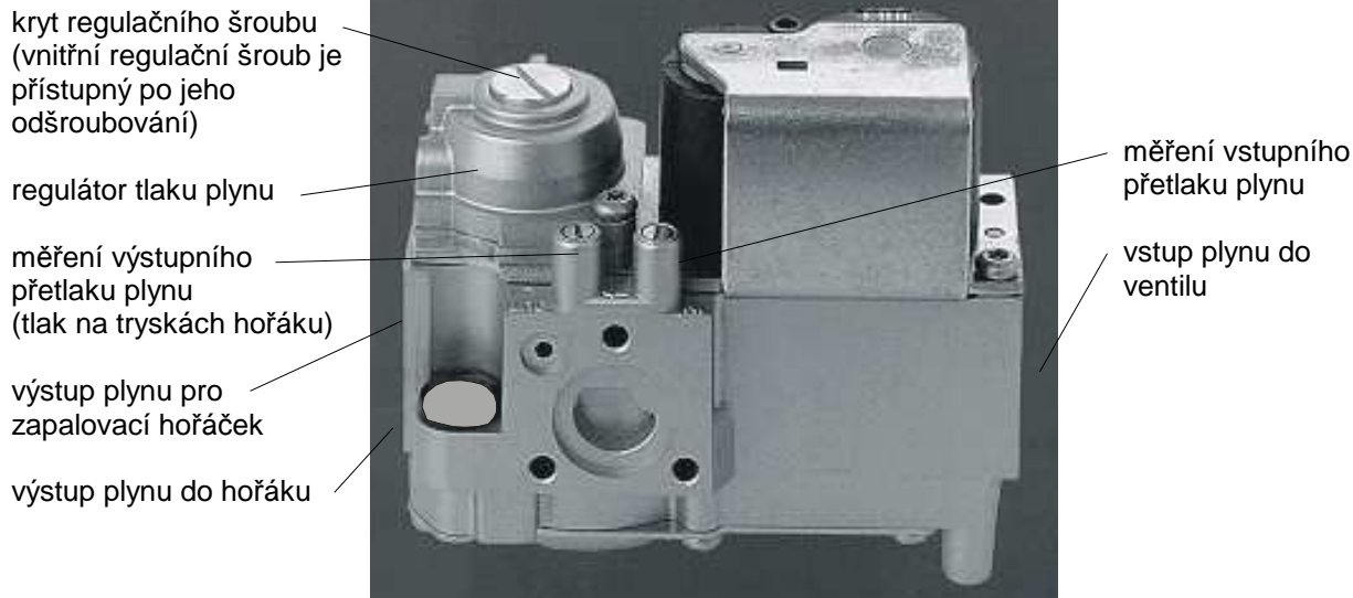
Obr. č. 31 Plynový ventil Honeywell VK 4100 A 1002
