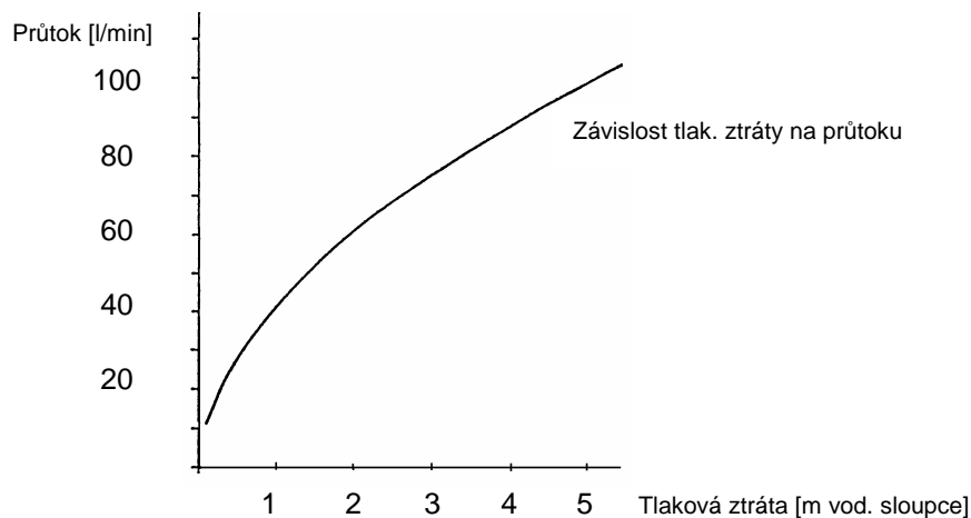
Obr. č. 9 Charakteristika trojcestného ventilu Honeywell V 4044F
